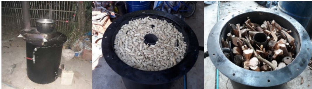
ภาพที่ 1 ลักษณะเครื่องปฏิกรณ์ไฟโรไลซิสรวมเตาชีวมวลและชีวมวลที่ใช้ในการผลิตถ่านชีวภาพ
